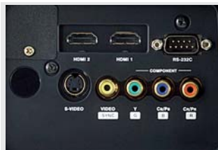
Neben zwei HDMI-Buchsen bietet der HD1 Composite-, S-Video- und Komponenten-Eingänge. Letztere können auch als RGB-Eingänge genutzt werden.
