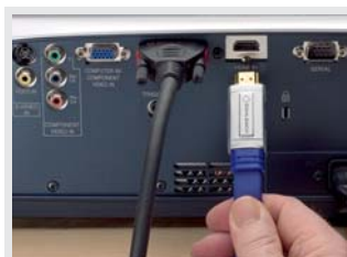
Der HC5000 besitzt DVI-D und HDMI-Anschluss für digitale Zuspiegelung. Bei analogem Anschluss entstehen sehr deutliche Schärfeverluste bei 1.920 x 1.080 Pixel.
