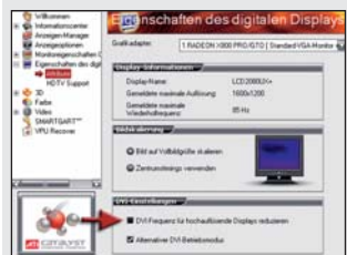
Für die digitale Zuspiegelung ist das Ausschalten von „DVI-Frequenz für hochauflösende Displays reduzieren“ erforderlich, weil sonst das Bild völlig verzerrt erscheint.
