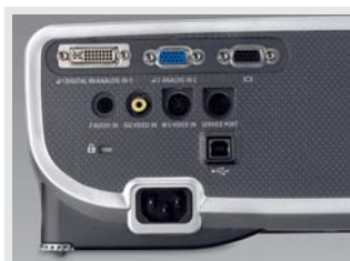
Das Anschlussfeld lässt keine Wünsche offen. Die DVI-I-Schnittstelle unterstützt auch HDCP, so dass Video-DVDs digital zugespielt werden können.
